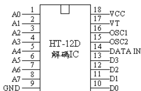
圖 6. HT-12D 解碼 IC 接腳圖
